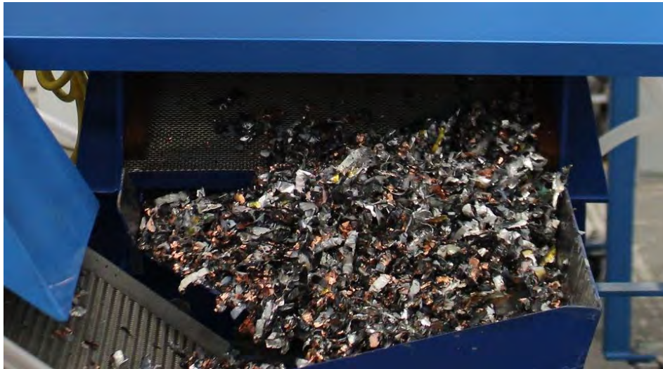
Figura 37. Materiales de LIB cuyo tamaño se ha reducido mediante trituración mecánica (Fuente: Li-Cycle proceso de reciclaje, https://www.energy-storage.news ).
