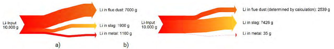
Figura 40. Ejemplo de distribución de litio en el reciclaje pirometalúrgico: a) enriquecimiento en polvo de combustión y b) enriquecimiento en escoria
