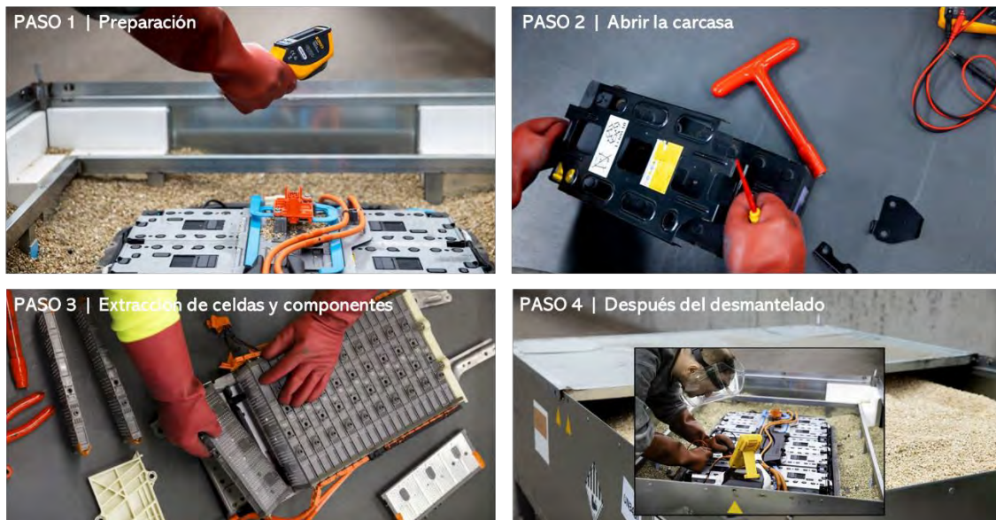
Figura 33. Pasos generales para el desmantelamiento de una batería EV.
